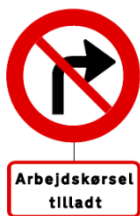
Figur 5.34 Eksempel på C 11 med undertavle som forbyder indkørsel til arbejdsområdet.
