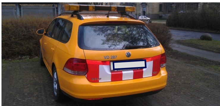
Figur 7.23 Eksempel på afmærkning af tilsynskøretøj med lygtebro og lodrette røde reflekser og hvid ureflekerende.
